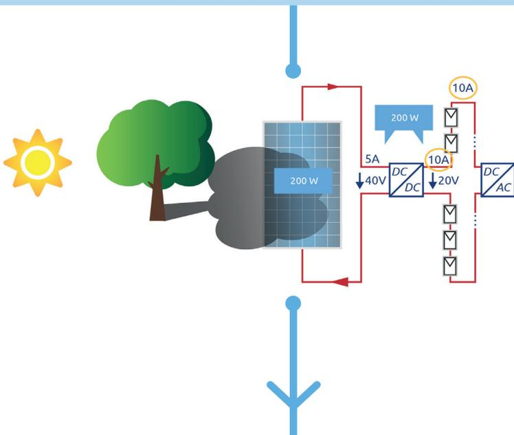
Im Beispiel wandelt der BRC Power Optimizer die Modulspannung von 40V und den Modulstrom von 5A in eine Ausgangsspannung von 20V und einen Strangstrom von 10A um. Die Folge ist, dass der gesamte Strangstrom überall im Strang nun wieder 10A beträgt und jedes Modul 10A erbringen kann. Zwar ist die Spannung am teilweise verschatteten Modul geringer geworden, jedoch beeinflusst diese nicht die Spannung der anderen Module.
