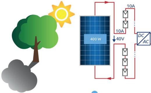
Bei Betrachtung der elektrotechnischen Situation zu optimalen Lichtverhältnissen, ist erkennbar, dass ein Modul im Beispiel 400W produzieren kann. Es herrscht eine Spannung von 40V an jedem Modul und ein Strangstrom von 10A im Gesamtsystem.
