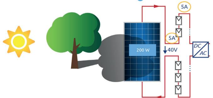
Moderne Wechselrichter können dieses Problem umgehen, indem sie die Bypassdioden der Module aktivieren. Wird die Bypassdiode aktiviert liefert der verschattete Zellstrang seinen maximal noch möglichen Strom und die Differenz zum Strangstrom fließt durch die Bypassdiode.
