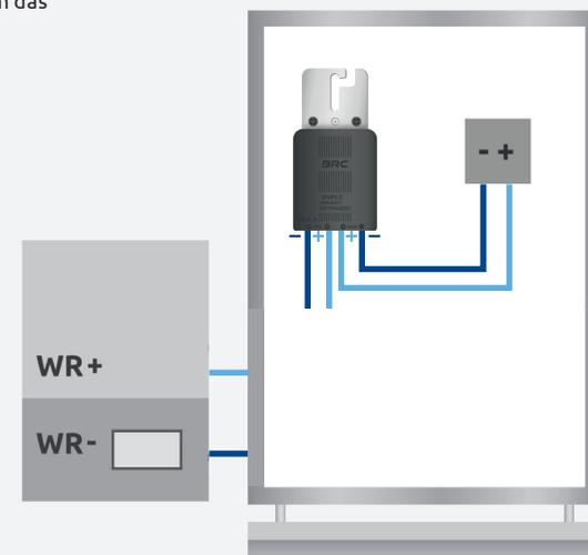
**3** Die langen Kabel werden strangseitig angeschlossen.
