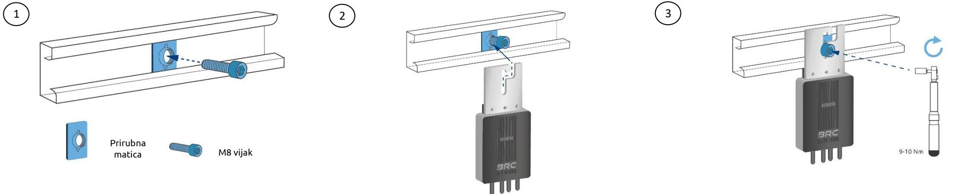
Postavite prirubnu maticu s vijakom M8 u montažni okvir.
