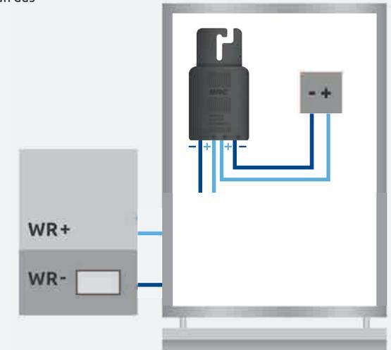
**3** Die langen Kabel werden strangseitig angeschlossen.
