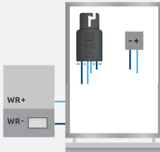
**2** Schließen Sie zuerst die kurzen Kabel an das PV-Modul an.
